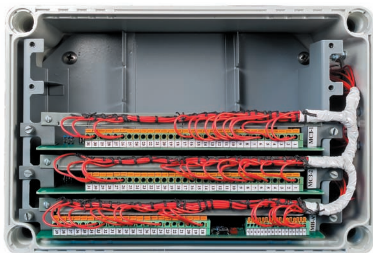
Рис. 13. БМ5-М без крышки с электронными модулями
